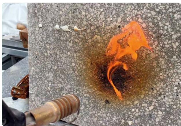
Test di comportamento alla fiamma secondo la norma EN 13501-1 Flame behaviour tests following EN 13501-1
